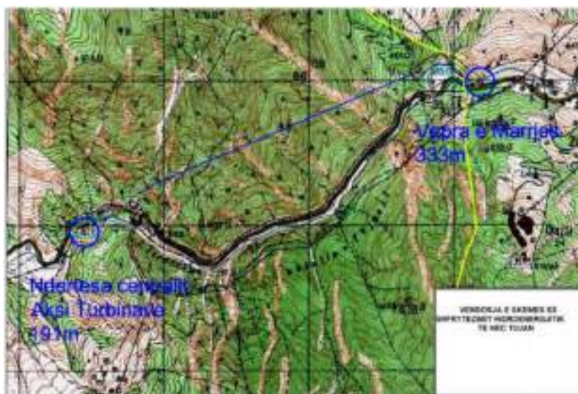
Fig. 169: Skema e ndërtimit të HEC Tujan mbi lumin e Shupalit (Tiranës)
